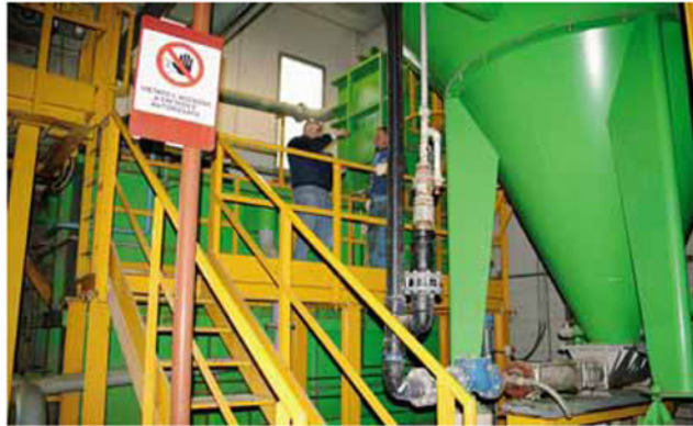
L'impianto Esposito in grado di recuperare oltre il 70% dei rifiuti provenienti dallo spazzamento delle strade
