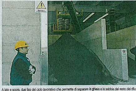
A lato e sopra, due fasi del ciclo lavorativo che permette di separare la ghiaia e la sabbia dal resto dei rifiuti
