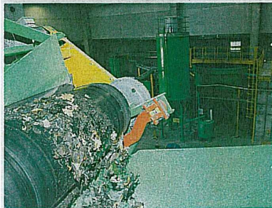
A lato e sopra, due fasi del ciclo lavorativo che permette di separare la ghiaia e la sabbia dal resto dei rifiuti
